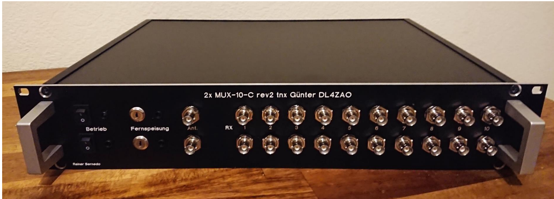
Zwei MUX-10C Module in einem 19 Zoll Rack als Verteilverstärker für 2 Antennen auf je 10 Ausgänge (Foto: Rainer Bernedo)
