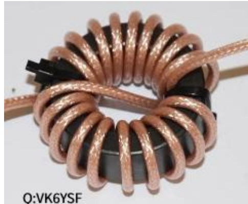
Cross-over Wicklung nach Joe Reiser. Ein- und Ausgang liegen gegenüber; weniger Übersprechen.
