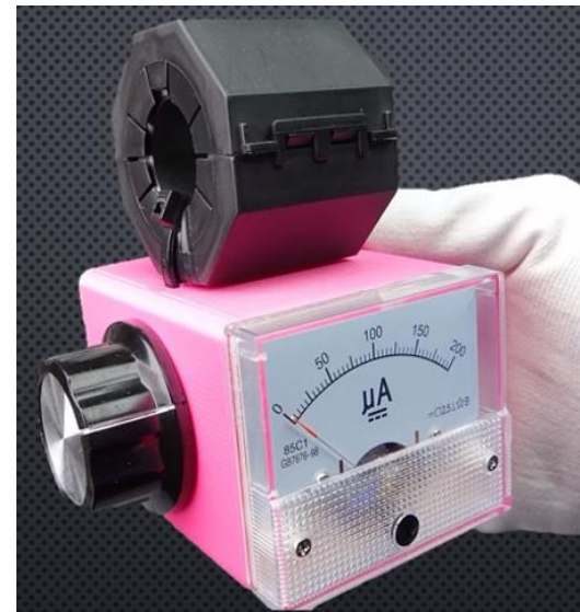
DIY HF Stromzange mit Klappferrit Bauvorschlag von HB9BLA Video dazu: „Problem Solver“
