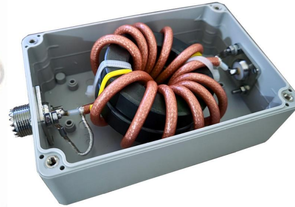
BalUn / Gleichtaktdrossel, In-Out auf Buchse, zum Einfügen in eine Speiseleitung
