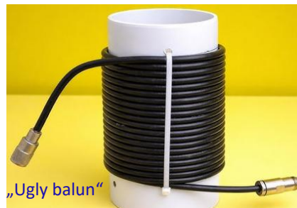
Koaxkabel als Luftspule aufgewickelt. L ist nur für obere KW-Bänder ausreichend
