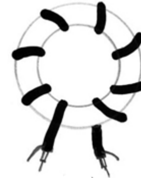
Koaxialkabel auf einem Ferrit- Ringkern oder Doppellochkern. Durchgehend oder mit „cross- over“ Wicklung nach J. Reiser W1JR (unter Beibehaltung des Wickelsinns !)
