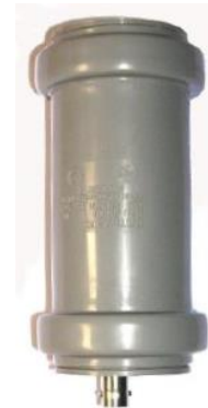
Bild 1 Schaltbild der ursprünglichen Mini-Whip nach PA0RDT, wetterfest montiert in einer PVC-Rohr-Muffe
