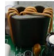
Die „Patentwickel“ Drossel auf BN73-0202 Ferrit Doppellochkern. Ferritmaterial #73 oder N30 ist oberhalb von einigen MHz verlustbehaftet, so dass die Drossel dort durch ihren Verlustwiderstand bedämpft wird. Die Eigenresonanz ist unterdrückt. Ideal als Breitbanddrossel. Funktioniert fast genauso gut, wenn nur der Mittelsteg bewickelt wird.
