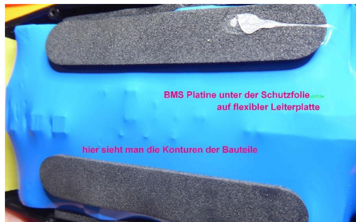
Mein Foto vom Akkupack mit BMS in der Schrumpfschlauch Hülle
