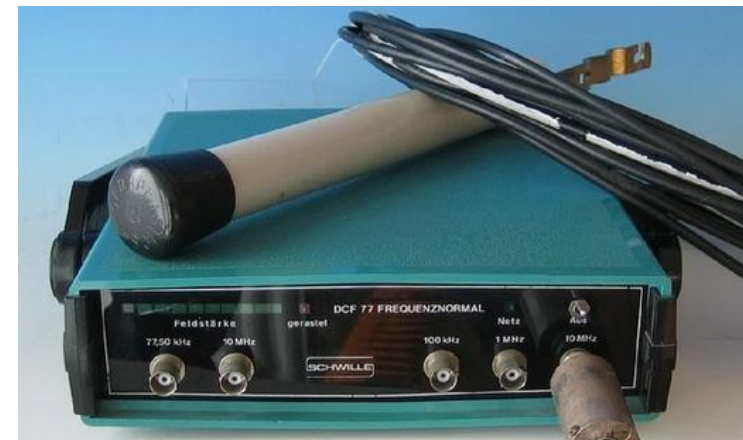
Schwille Frequenznormal mit DCF-77 Korrektur
