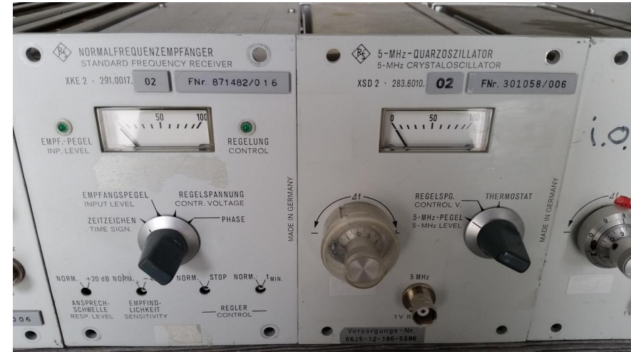
R & S Rubidiumfrequenznormal mit DCF-77 Empfänger XKE-2
