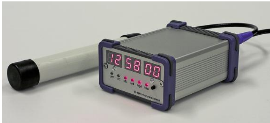
10 MHz – Frequenznormal mit DCF-77 Synchronisation 090529 („Funkamateu“ 2009)
