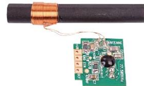
DCF77 Antenne/ Empfangsmodul für billige Consumer Uhren (China)
